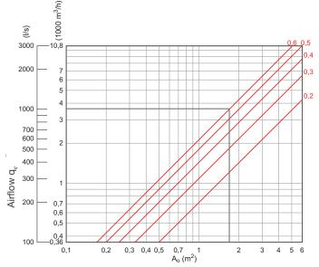
Maximum airflow: 0,6 m/s \*1,8  $m^2 = 1,08 m^3/s = 1080 l/s$
