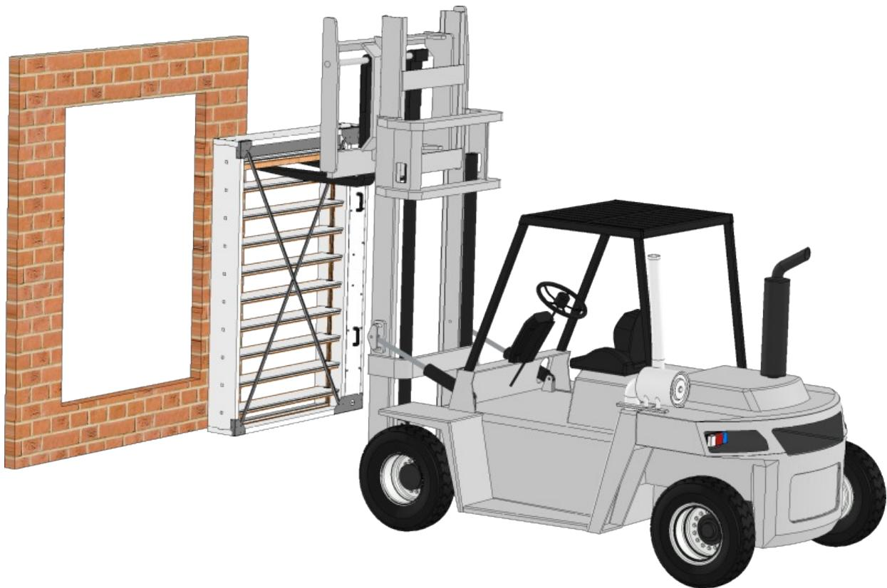
5. Pärast klapi paigaldamist ja krohvi/mördi võimalikku kõvastumist eemaldada transportimisel kasutatud kLOTSID ja nurgatükit.
