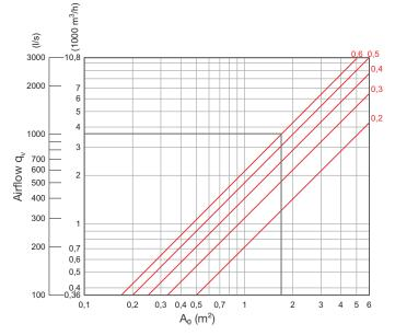
Maximum airflow: 0,6 m/s \*1,8 m<sup>2</sup> = 1,08 m<sup>3</sup>/s = 1080 l/s
