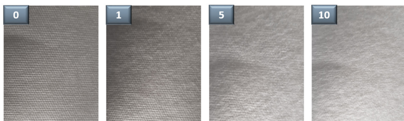
Foto 4. Fotod testitud Airfelt polüestrist, kus vasakul üleval nurgas olev number näitab töötlemiste arvu enne foto tegemist.
